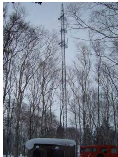
蒸発散量算定のための機器 (樹冠上蒸発散量観測システム)
